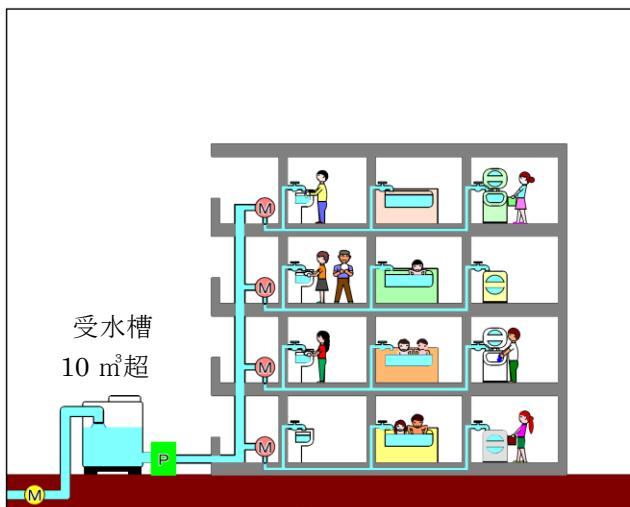
高架水槽方式の場合(受水槽合計 10 m<sup>3</sup>超えるもの)
